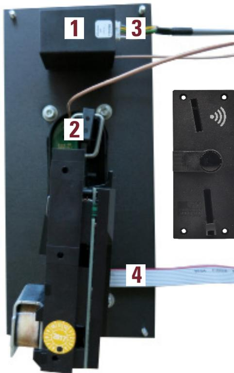
**1. MDB-Module mit dem Klettverschluss im Automaten befestigen. *Wir empfehlen das MDB-Modul nicht auf das Münzgerät zu kleben!***
